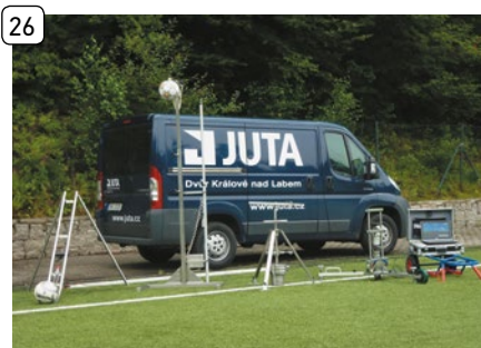
26 Měření herních parametrů dle FIFA
