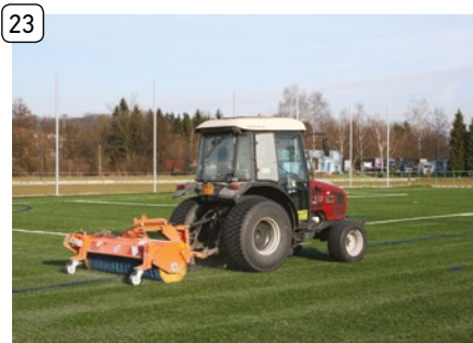
23 Kartáčování po zapravení zásypu - písek
